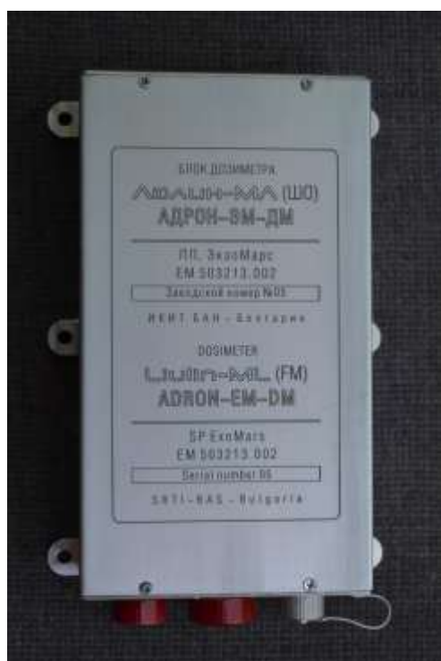
Фиг.1. Летателна апаратура „Люлин-МЛ“ за радиационни изследвания по космическия проект „ЕкзоМарс 2020“.
